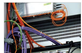
LWL und Kupfer Verkabelung im Übertragungswagen
